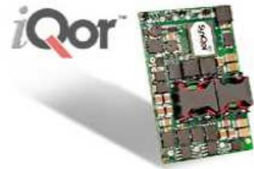
iQorパワーインタフェースモジュールは、1/4ブリックサイズでATCA (Advanced Telecommunications Computing Architecture)の電源入力フレームボードとして要求される全ての要素を集積しており、僅かな外部部品でATCAの全ての主要機能が実現できます。SynQor社のBusQorもしくはPowerQorのような電力供給用DC-DCコンバータと共に使うことにより、ATCA仕様の基板をデザインするにあたり高電力密度ソリューションを提供します。
